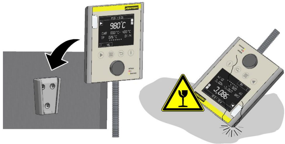
Afb. 30: controller in de houder aan de oven plaatsen (afbeelding vergelijkbaar)
