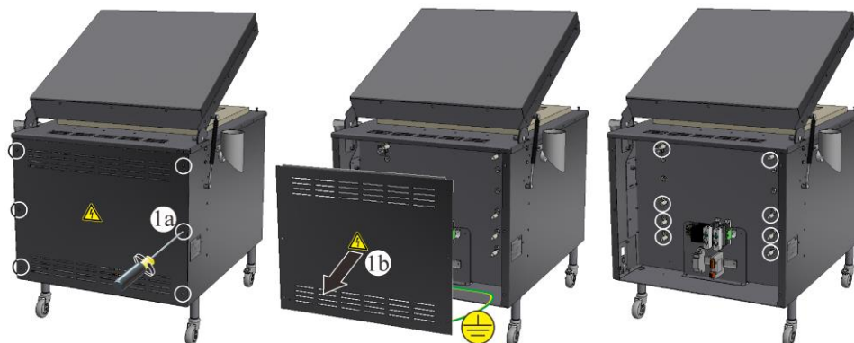
Afb. 57: afdekking van de schakelinstallatie aan de achterzijde van de oven demonteren (afbeelding vergelijkbaar)
